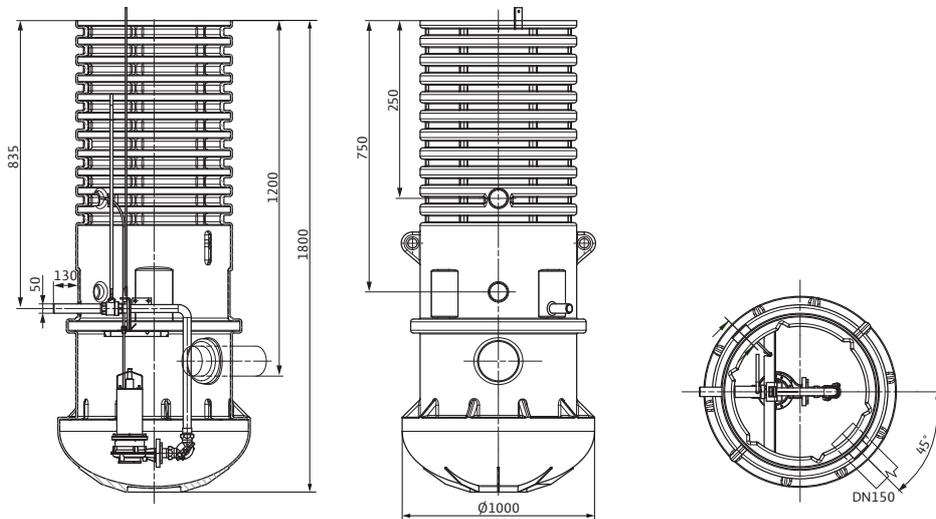
Размеры и габаритные чертежи: Wilo-DrainLift WS 830 E/1800
